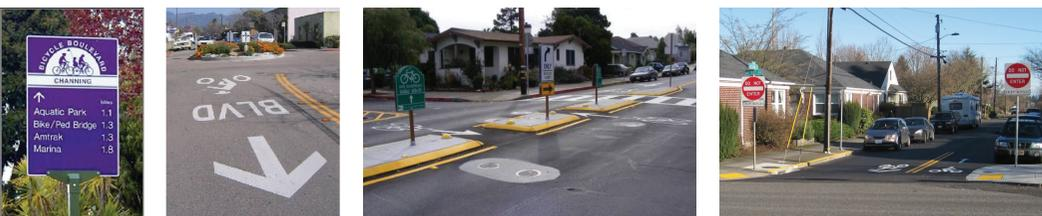
Los Ciclo bulevares son calles con poco tráfico, diseñadas y designadas para dar prioridad al uso de la bicicleta. Los Ciclo bulevares usan señales de tráfico, señales en el pavimento, y medidas de control de velocidad y volumen de vehículos para disminuir el congestionamiento y crear un ambiente seguro para andar en bicicleta (Según la Asociación Nacional de Funcionarios del Transporte Urbano).
